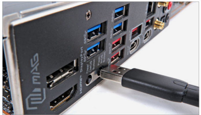
Vorsicht, wenn Kabel blind hinter dem Rechner angeschlossen werden sollen: MSI platziert den ungeschützten UEFI-Reset-Knopf unangenehm nah an USB-Ports.
