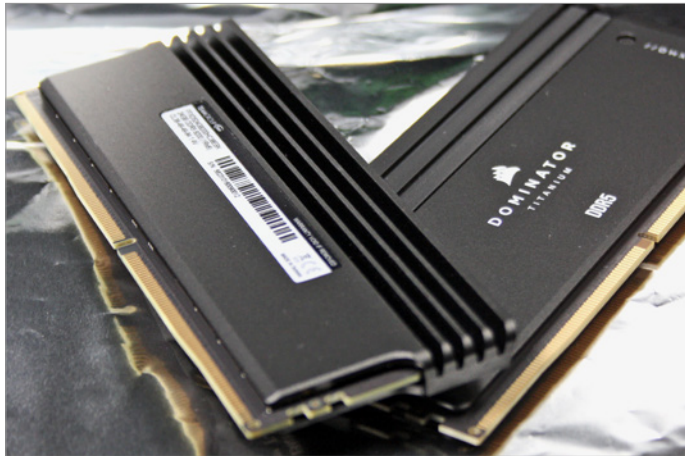
Die Kühlsten im Test: Dank grober Kühlkammern bleibt der 84 g schwere Teamgroup-Stick noch etwas kühler als die 74 g schwere Corsair-Konstruktion mit RGB-LEDs.
